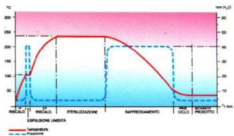
En primer lloc s'esclafa per eliminar l'aigua (assecat), s'arriba a 100°C. Una cop s'ha eliminat l'aigua es continua l'escalfament fins arribar a la temperatura d'esterilització (propera als 250°C). Es manté la temperatura per a produir l'esterilització. Una cop s'ha produït l'esterilització es produeix el refredament fins a la temperatura ambient.
