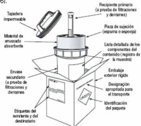
**Figura 6.** Ejemplo de sistema de embalaje/ensado triple para el embalaje y etiquetado de sustancia infecciosa de categoría B.
