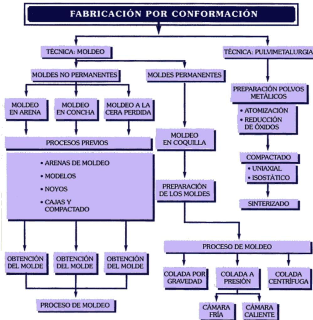
El moldeo es una técnica que consiste en calentar el material hasta su punto de fusión y, en ese momento, verterlo en un molde con la forma de la pieza que se pretende obtener.
