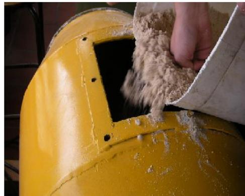
**Figura 27.** Colocación de arena en la mezcladora.
