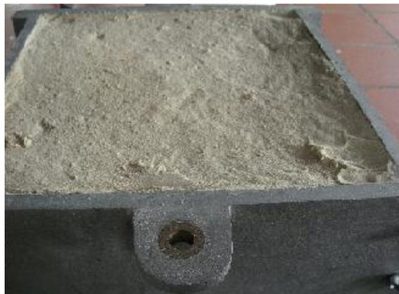
**Figura 39.** Arena apisonada y aplanada en la superficie de la caja
