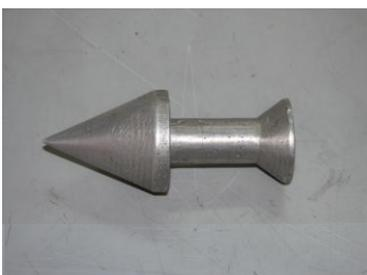
Para facilitar el proceso de verter el metal fundido en la cavidad de arena, el extremo del bebedero tiene forma cónica. Para lograr esta forma el trompo se presiona en la boca de la cavidad que deja el tubo al salir de la arena.
