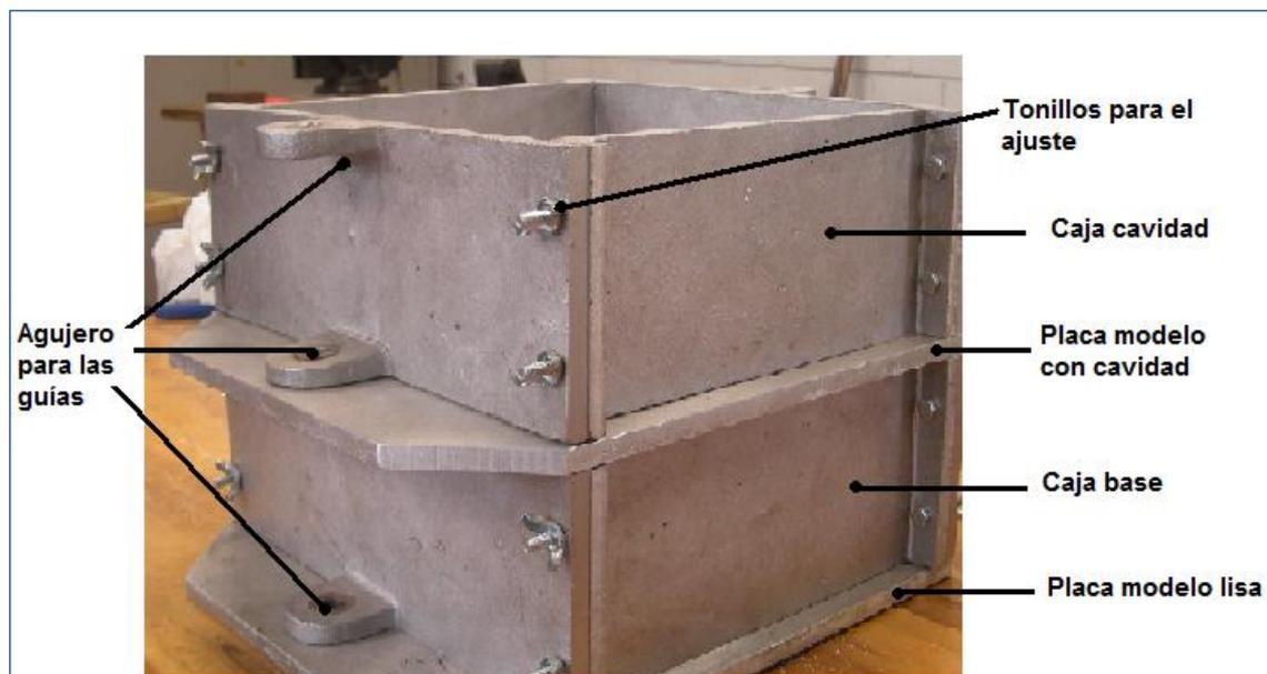
**Figura 30.** Cajón de fundición
