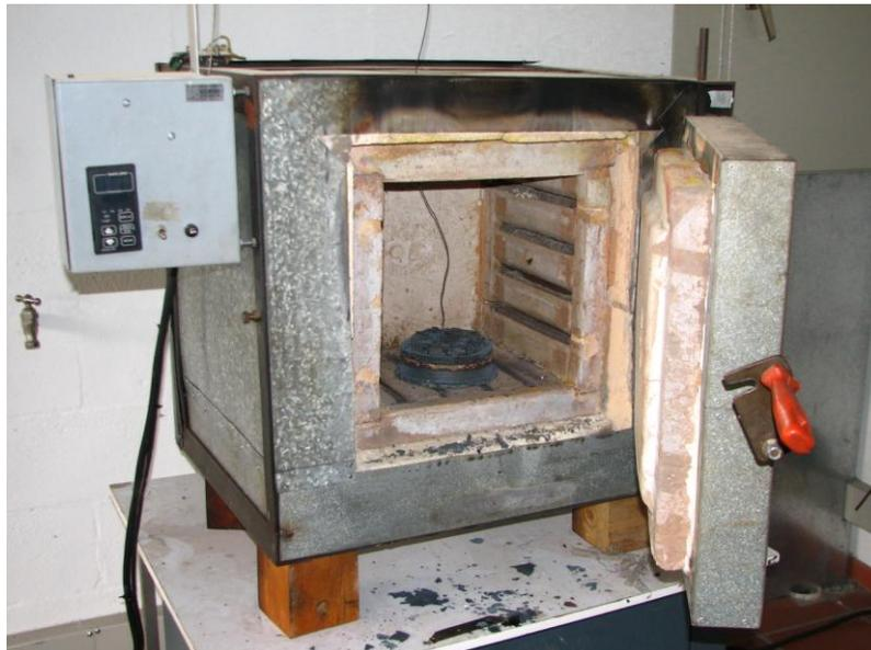
**Figura 16.** Horno del laboratorio: Eléctrico a resistencia.
