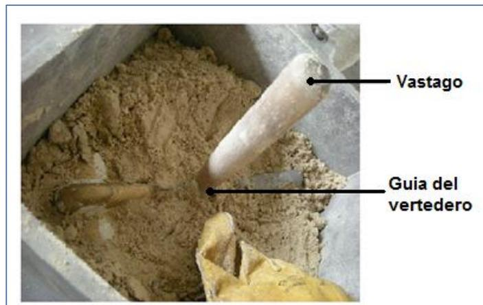
**Figura 32.** Ubicación del vástago y aplicación de arena en la caja cavidad
