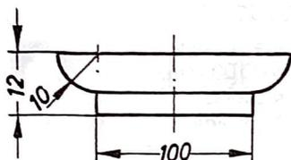
161. Se desea obtener, partiendo de plancha, una pieza como la del dibujo.
