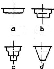
El dibujo adjunto nos presenta diversas fases, necesarias, para la embutición de un recipiente de forma cónica. Siempre debemos procurar obtener por medio de embuticiones escalonadas, una figura próxima a la final, siendo la última operación la que nos da la forma definitiva.
