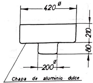
b) Según tabla el valor de  $K_0$  y  $K$  son 0,55 y 0,8 respectivamente. A continuación determinamos los diámetros de sucesivas embuticiones, y al mismo tiempo determinamos el número de pasadas. En piezas de este tipo se embute siempre a embutir la parte central.
