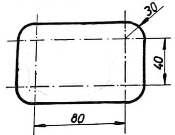
168. Calcular el diámetro  $D$  del disco, cuya superficie permite embutir la pieza del dibujo.
